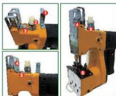
Поверните по часовой стрелке – стежок будет плотным, против часовой – свободный стежок. Ослабьте винт и переместите зубец подачи вверх длинным стежком, противоположный – с коротким.
